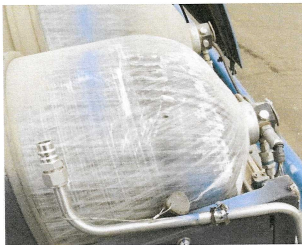
图 B.3 磨损(二级损伤)
