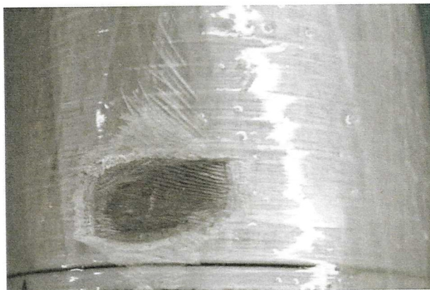
图 B.3 磨损(二级损伤)
