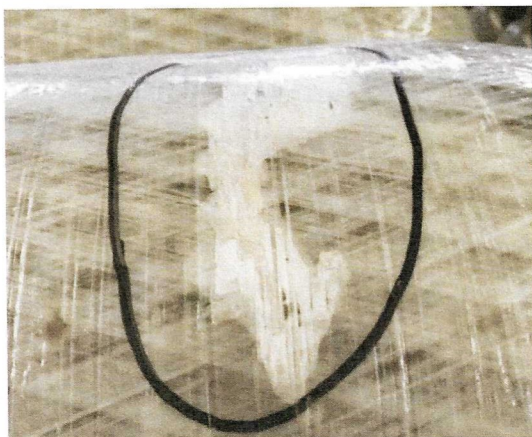
图 B.9 冲击损伤(二级损伤)
